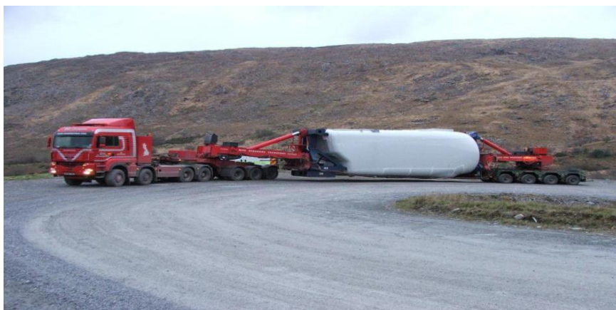
Фиг. 2.1-3. Транспорт на елементи от ветрогенератора
