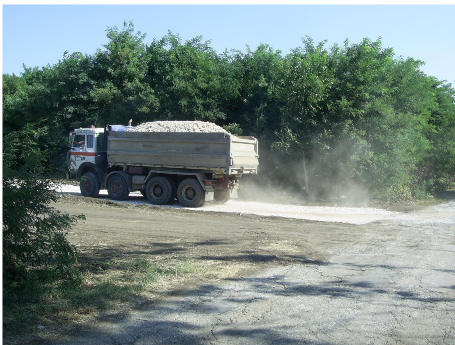
Фиг. 6.1.1.1-1. Запрашаване при движение на автосамосвал по очакълен път
