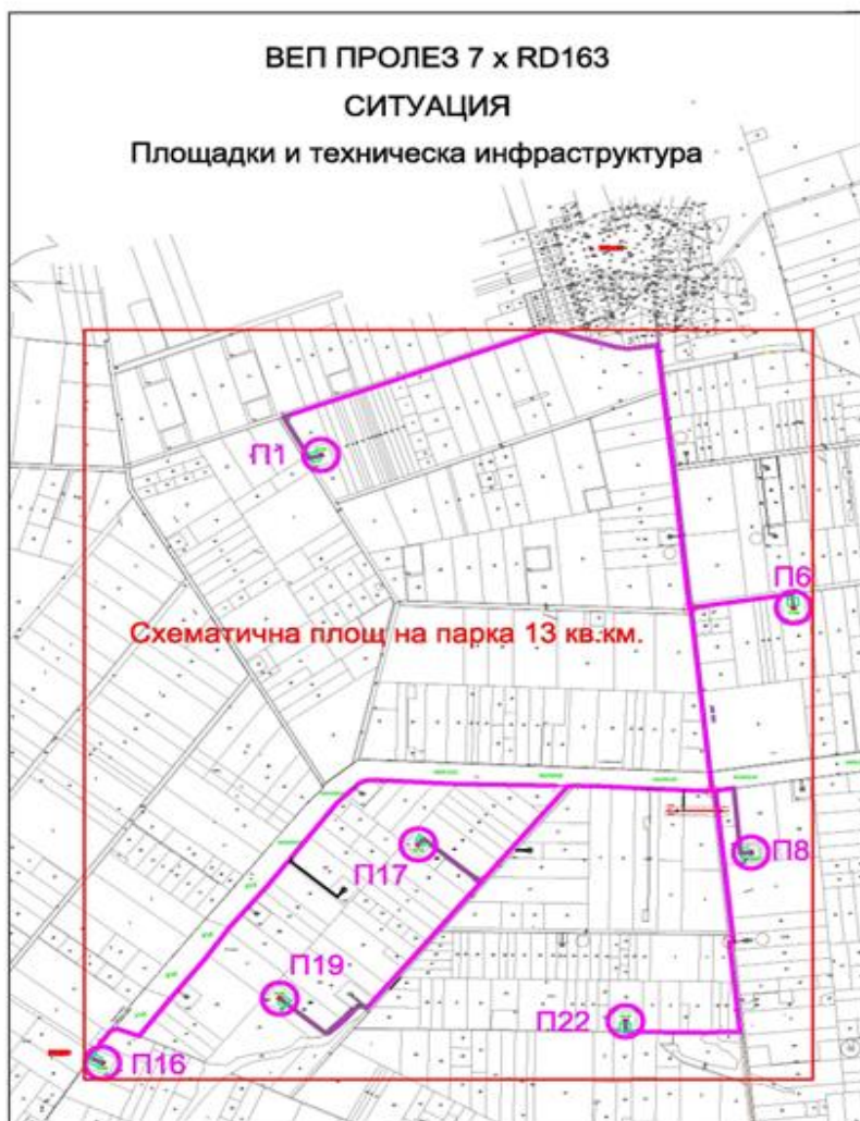
Фиг.№ 2-8 Разположение на турбините във ВЕП Пролез
